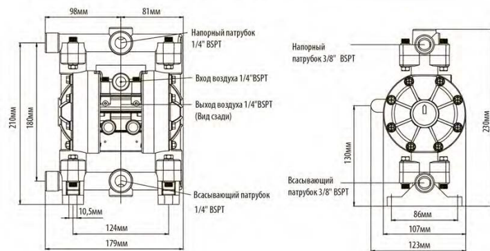
Габаритные и монтажные размеры насоса MK06
