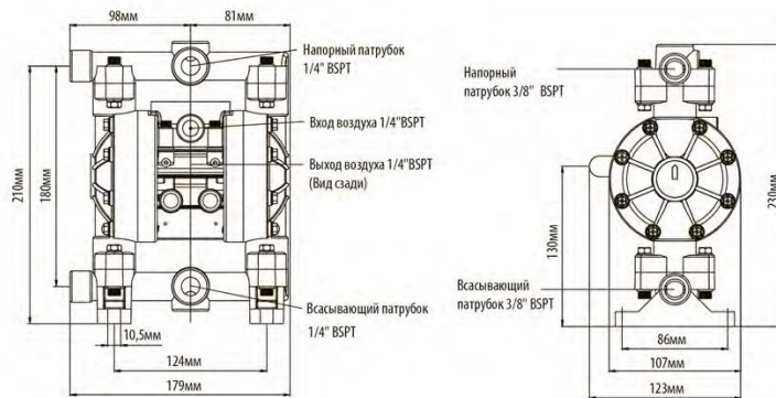
Габаритные и монтажные размеры насоса MK06
